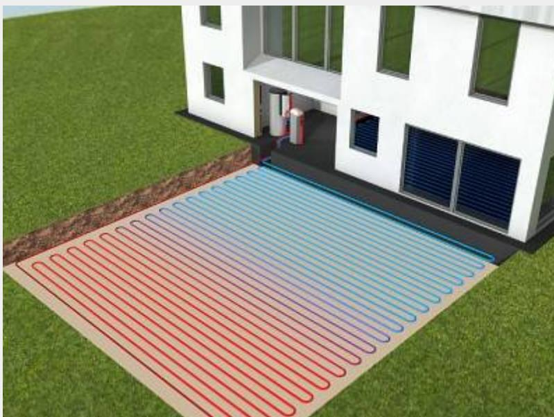
Pompe à chaleur géothermique par [Bioclimatic Technology](#)
