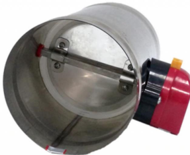
Le clapet peut être ouvert ou fermé en fonction du circuit alimenté. La connexion du milieu (n°2 sur le diagramme ci-dessous) correspond à l'alimentation 12 volts et est toujours alimenté. Si le port 1 est relié à la masse, le clapet se ferme. Si c'est le port 3 qui est relié à la masse, le clapet s'ouvre. Il n'est pas possible d'alimenter les 3 connectiques en même temps.
