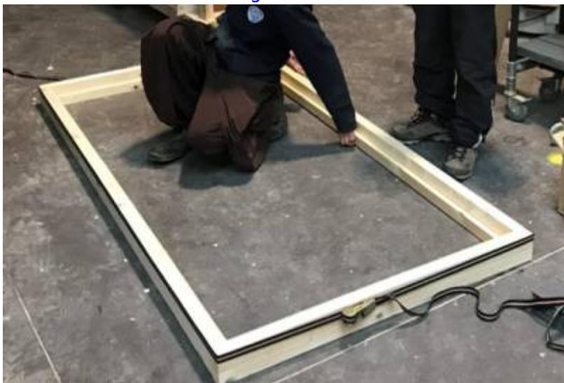
Afin de correctement fixer les chevrons entre eux sans éclater le bois, il est nécessaire de faire un préperçage dans les chevrons sur laquelle la tête de vis va reposer. Pour réussir ce pré-perçage, utilisez un forêt bois de même diamètre que votre vis (ici un diamètre 5mm).
