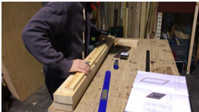
1. Pour les chevrons et les lattes de courte dimension: Visser les lattes sur les chevrons associés à 25mm des bords, espacé de 9mm du haut et de 53mm du bas.
